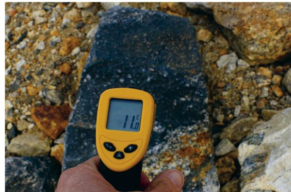
L'appareil pointé sur les 2 pierres côté à côté est un capteur laser qui indique la température de la pierre.
